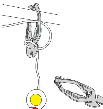
Mithilfe des Geräte- und Kabelhalters lässt sich die Birntaster oder die PBK Hand komfortabel am Bettgagel befestigen.
